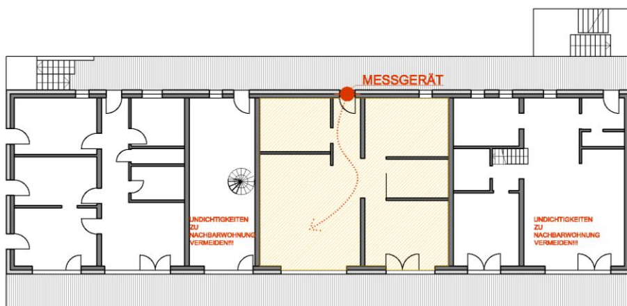
Grafik 16: Luftdichtheitsmessung beim Gebäudetyp „Laubengang“
