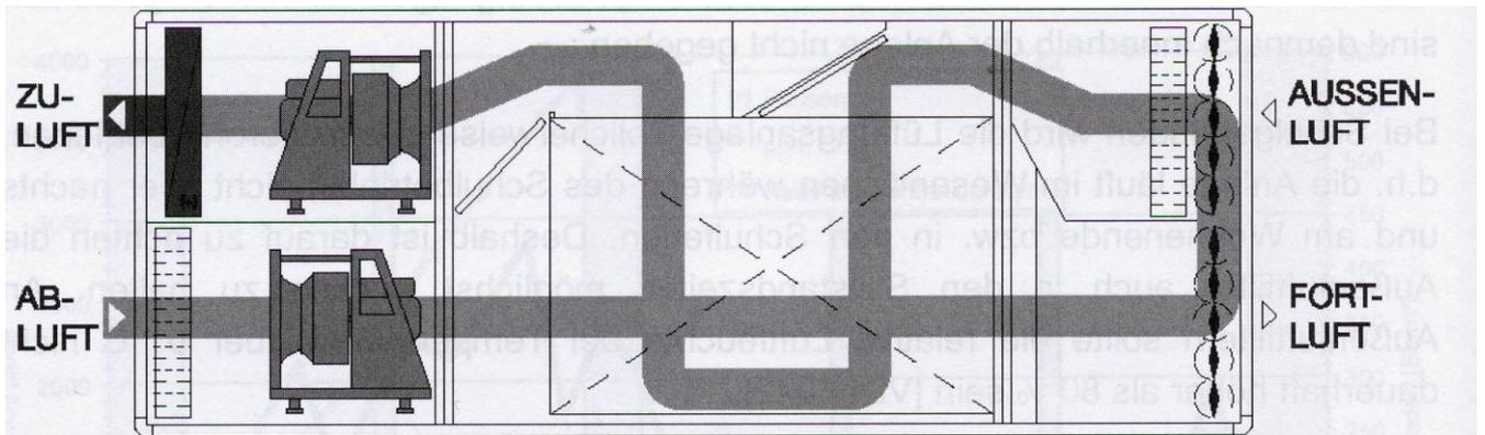
Abbildung 5: Einfachste Form der Filtertrocknung durch Umluftbetrieb (Quelle: Menerga)
